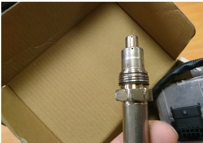
Figura 11. Rosca y tuerca dañados.
