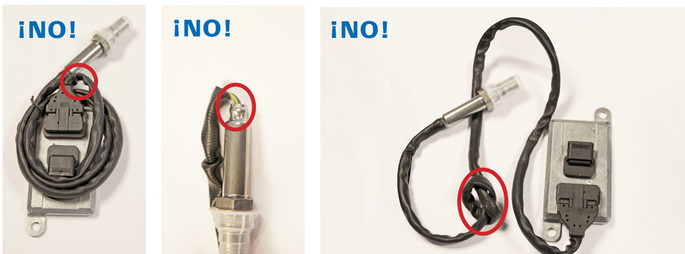
Figura 5. Manejo inadecuado del cable.
