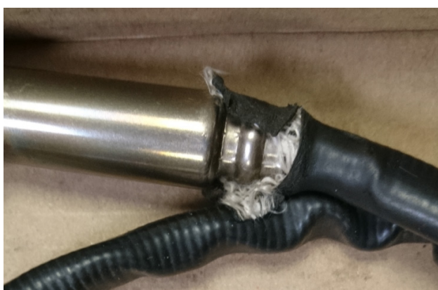
Figura 14. Evidencia de cableado dañado.
