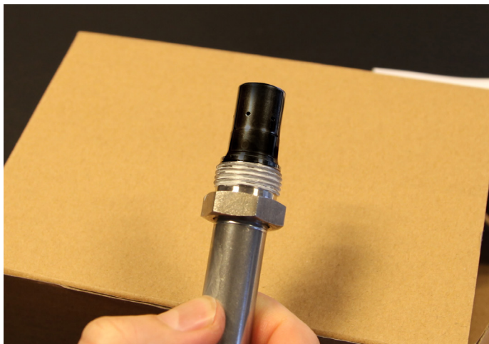
Figura 12. Figura 12. Evidencia de hollín / ceniza excesivos.
